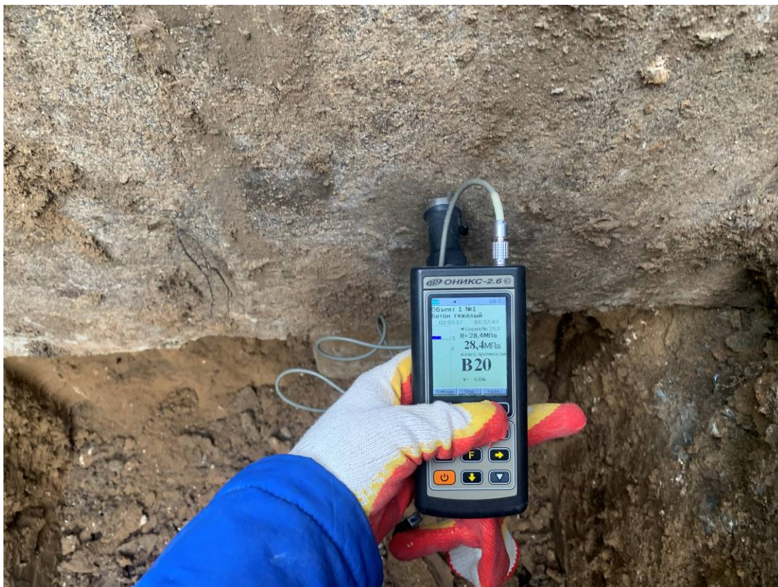
Рисунок 3.4 Определение прочности бетона ж.б. ростверка методом ударного импульса с помощью прибора ОНИКС-2.6
